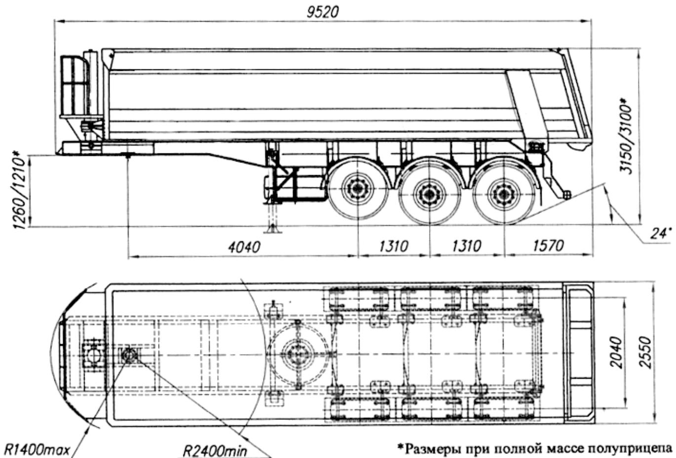
\*Размеры при полной массе полуприцепа
